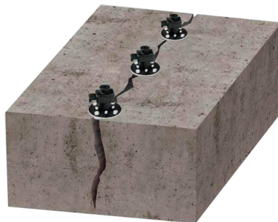
б – установка поверхностных (клеевых) пакеров в бетоне без устройства шпуров
