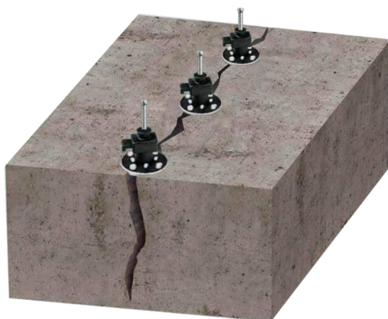
а – установка поверхностных (клеевых) пакеров
