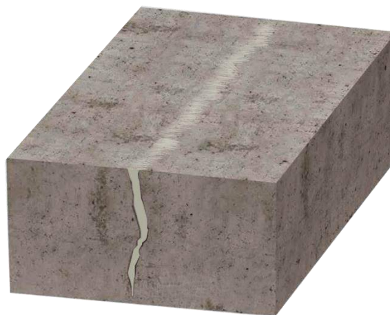
г – выравнивание поверхности после снятия пакеров
