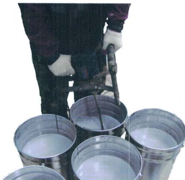
Рисунок 10 - Перемешивание краски ОК-ДМ с помощью электродрели с насадкой
