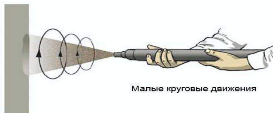
Управление торкрет-форсункой для равномерного нанесения торкрет-бетона на поверхность
