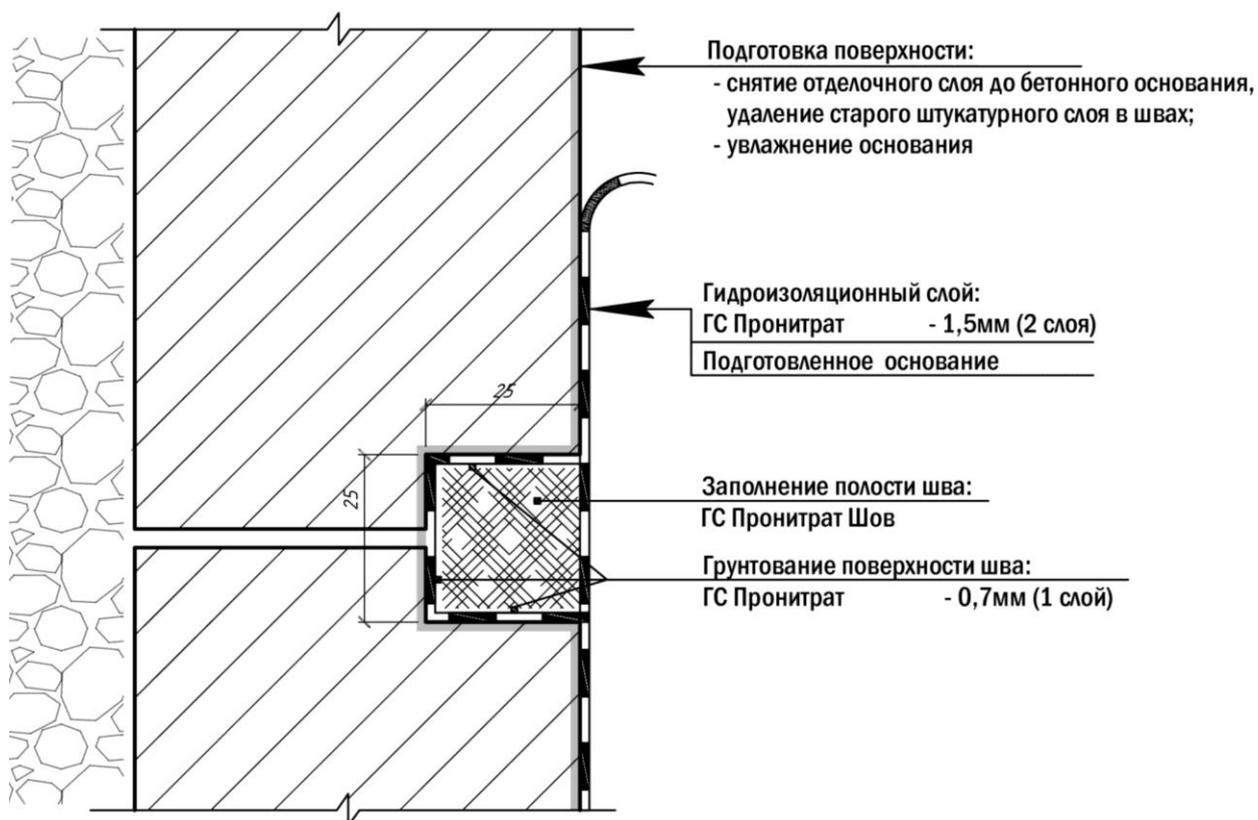
Рисунок Б.3 – Узел 1: устройство гидроизоляции швов кладки фундаментных бетонных блоков
