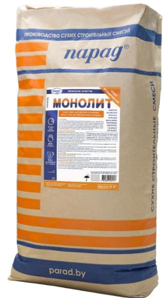
**МОНОлит** – засыпка для установки опор и стоек методом сухого бетонирования, который заключается в заливке водой сухой смеси без предварительного приготовления раствора. В течение 4 часов уложенный таким способом материал твердеет и приобретает прочность. Сухое бетонирование допускается при установке конструкций, не испытывающих значительных нагрузок и воздействий при эксплуатации.
